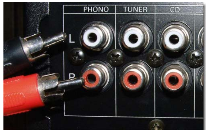
Die Variante: Der Plattenspieler wird an den Phono-Eingang der Stereo-Anlage angeschlossen.
