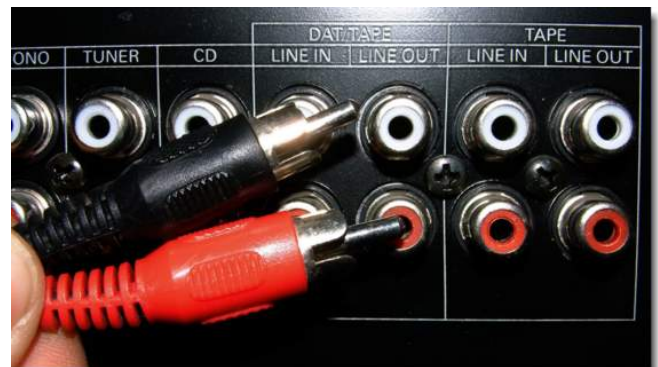
Von dort geht's vom Line Out zum Line In des Computers.
