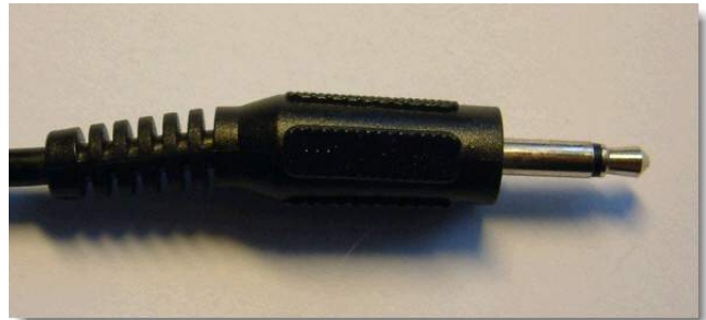
Dieser Stecker hat nur einen Isoliererring. Es handelt sich also um einen Mono-Stecker, welcher ungeeignet ist.
