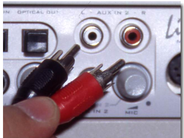
Viele Soundkarten der gehobenen Klasse bieten auch mehrere analoge Eingänge.
