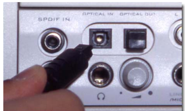
Ein optischer Eingang. Links davon ist der koaxiale Eingang zu sehen.
