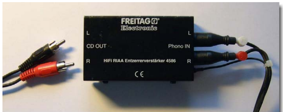
Ein kleiner Entzerr-Vorverstärker. Diese Marke (Freitag) ist in den Geschäften schon länger nicht mehr zu finden. Annähernd baugleiche wie der der Firma Vivanco (Vertrieb z.B. über Conrad) tun aber genauso den Dienst. Rechts wird der Plattenspieler angeschlossen, links geht's zum Line In des Computers.
